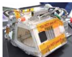
JAXAが中心となって開発したマウス飼育装置
