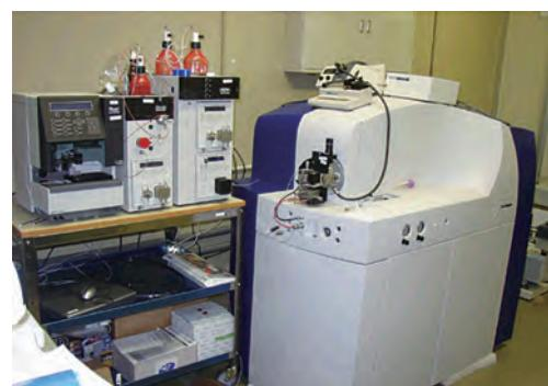
図2：MS/MS型質量分析装置
