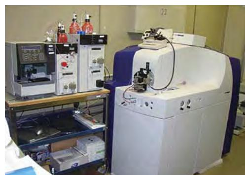
図2：MS/MS型質量分析装置
