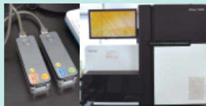
微研に設置されている次世代シーケンサー MinION(左)、HiSeq3000(右)
