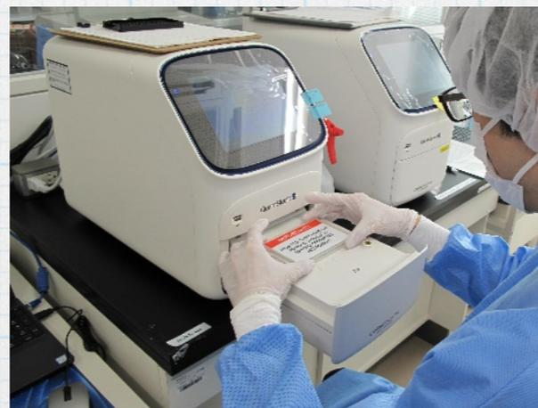
PCR装置にセットし測定開始
